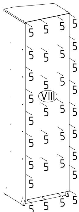
Для установки задней стенки необходимо проверить и выровнять длину диагоналей корпуса пенала и сделать предварительную разметку в местах крепления задней стенки к полкам.
