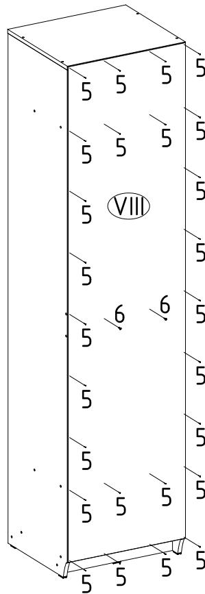
Для установки задней стенки необходимо проверить и выровнять длину диагоналей корпуса шкафа и сделать предварительную разметку в местах крепления задней стенки к полкам и ребру жесткости.
