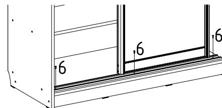
Подвесить дверь (IX) к боковой стенке корпуса, выставить нижний трек (XI) таким образом, чтобы дверь была параллельна передней кромке боковой стенки и закрепить нижний трек (XI) одним саморезом (6). Проделать тоже самое относительно второй боковой стенки, саморезы (6), крепящие середину нижнего трека (XI) – заворачивать в последнюю очередь.
