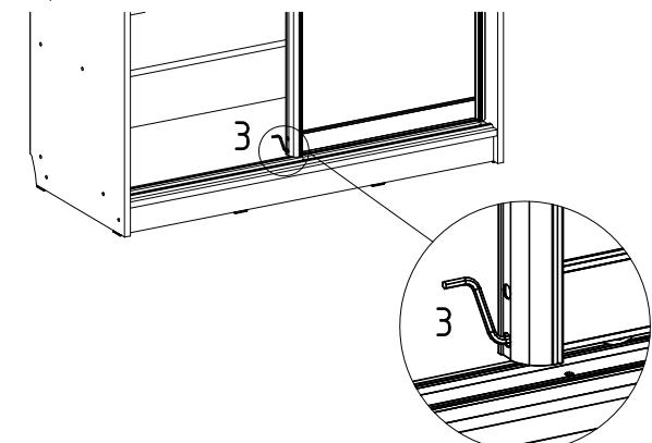
Вставить шестигранный ключ (3) в отверстие для регулировочного винта в вертикальном профиле двери (IX). Вращая ключом (3) регулировочный винт нижних роликов, отрегулировать положение двери (IX) таким образом, чтобы дверь (IX) по всей высоте плотно прилегала к соответствующей боковине, при этом нижний край двери (IX) не должен соприкасаться с нижним треком. Отрегулировать положение второй двери аналогичным образом.
