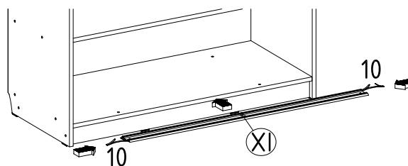
Установить стопора (10) в нижний трек (XI), по одному в каждую направляющую. Положить нижний трек (XI) на дно шкафа.
