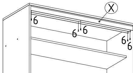
Закрепить верхний трек (X) саморезами (6) к крыше, выровняв его относительно боковин шкафа таким образом, чтобы верхний трек был утоплен вглубь корпуса шкафа на 3мм относительно боковин шкафа.
