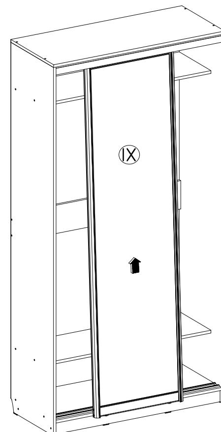
Наклонить дверь (IX) и вставить ее в верхний трек (X) до упора, приподнять подпружиненные нижние ролики двери (IX) руками и вставить в нижний трек (XI). При этом нижние ролики должны войти в пазы направляющих нижнего трека (XI). Первая дверь устанавливается в дальние направляющие верхнего (X) и нижнего (XI) трека, вторая дверь устанавливается в ближние направляющие.
