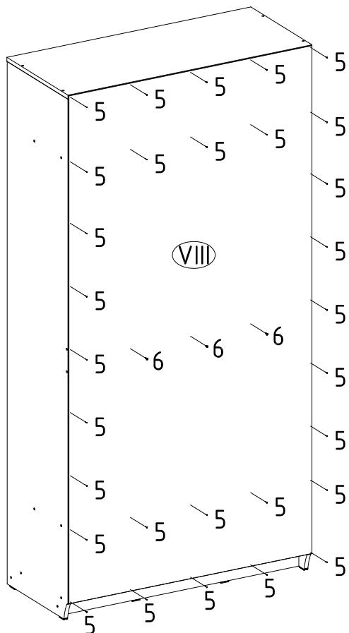
Для установки задних стенок необходимо проверить и выровнять длину диагоналей корпуса шкафа и сделать предварительную разметку в местах крепления задней стенки к полкам и ребру жесткости.
