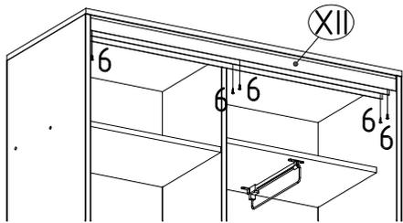
Закрепить верхний трек (XII) саморезами (6) к крыше, выровняв его относительно боковин шкафа таким образом, чтобы верхний трек был утоплен вглубь корпуса шкафа на 3мм относительно боковин шкафа.
