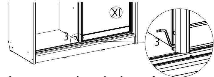
Вставить шестигранный ключ в отверстие для регулировочного винта в вертикальном профиле двери (XI). Вращая ключом регулировочный винт нижних роликов, отрегулировать положение двери (XI) таким образом, чтобы дверь (XI) по всей высоте плотно прилежала к соответствующей боковине, при этом нижний край двери (XI) не должен соприкасаться с нижним треком (XIII). Отрегулировать все двери аналогичным образом.
