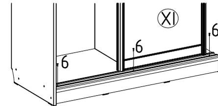
Подвести дверь (XI) к боковой стенке корпуса, выставить нижний трек (XIII) таким образом, чтобы дверь (XI) была параллельна передней кромке боковой стенки и закрепить нижний трек (XIII) одним саморезом (6). Прделать тоже самое относительно второй боковой стенки, саморезы (6), крепящие середину нижнего трека (XIII) - заворачивать в последнюю очередь.
