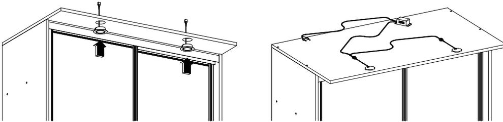
Установка врезных светильников показана на примере установки в двухдверный шкаф-купе. Установка врезных светильников в трехдверный и четырехдверный шкафы-купе производится аналогичным образом, отличия только в количестве светильников.
