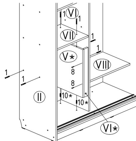
Установить на евровинты (1) заглушки (2). Фальшпанель (VI\*) крепить к перегородке (V\*) саморезами (8). После чего закрыть головки саморезов (8) самоклеящимися заглушками (9). Далее производится установка ящиков аналогичным образом, указанным для остальных шкафов-купе "РИКО".
