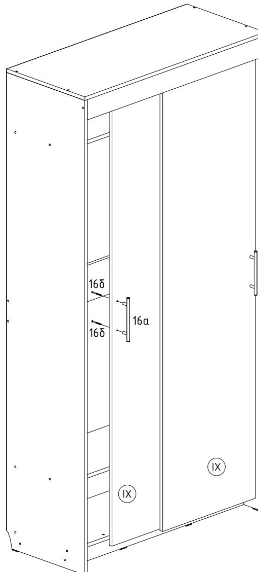
Установить ручки (16) на двери (IX). При необходимости просверлить по два сквозных отверстия сверлом Ø5мм для каждой ручки, сделав предварительную разметку. Во избежания повреждения детали, подкладывать с тыльной стороны под место сверления фальш-панель или брусков.
