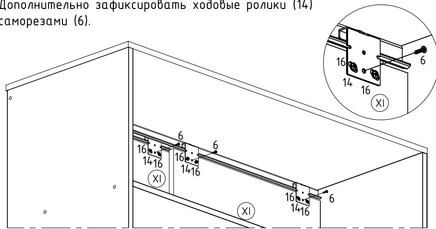
Положение средних дверей в трех- и четырехдверных шкафах регулируется относительно крайних дверей.
