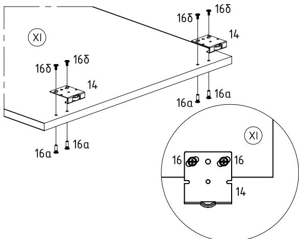
Закрепить уголки передней двери (11), для 2-х и 3-х и трехдверных шкафах на одной двери (XI), и уголки задней двери (12), для 2-х дверных шкафов на одной двери (XI), для 3-х и 4-х дверных шкафов на двух дверях (XI), саморезами (6).
