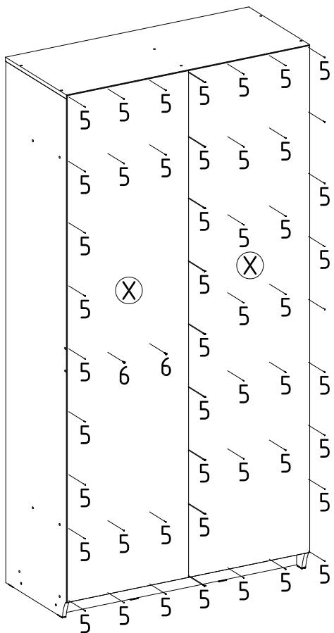
Для установки задних стенок необходимо проверить и выровнять длину диагоналей корпуса шкафа и сделать предварительную разметку в местах крепления задней стенки к полкам и ребру жесткости.
