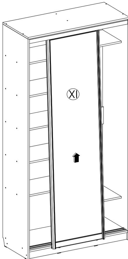
Наклонить дверь (XI) и вставить ее в верхний трек (XII) до упора, приподнять подпружиненные нижние ролики двери руками и вставить в нижний трек (XIII). При этом нижние ролики должны войти в пазы направляющих нижнего трека (XIII).
