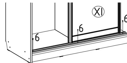
Подвести дверь (XI) к боковой стенке корпуса, выставить нижний трек (XIII) таким образом, чтобы дверь (XI) была параллельна передней кромке боковой стенки и закрепить нижний трек (XIII) одним саморезом (6). Прodelать тоже самое относительно второй боковой стенки, саморезы (6), крепящие середину нижнего трека (XIII) - заворачивать в последнюю очередь.
