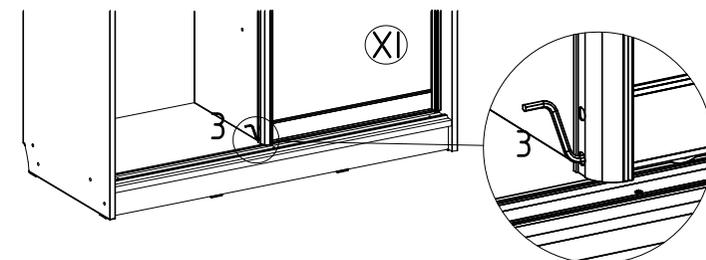
Вставить шестигранный ключ в отверстие для регулировочного винта в вертикальном профиле двери (XI). Вращая ключом регулировочный винт нижних роликов, отрегулировать положение двери (XI) таким образом, чтобы дверь (XI) по всей высоте плотно прилегала к соответствующей боковине, при этом нижний край двери (XI) не должен соприкасаться с нижним треком (XIII). Отрегулировать все двери аналогичным образом.
